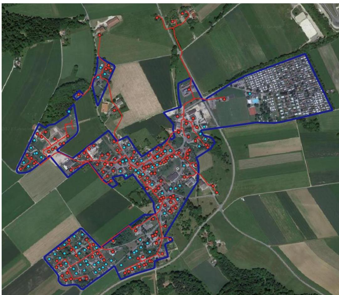
Figure 3. Tracé du réseau et représentation des bâtiments (points rouges : bâtiments déjà raccordés au CAD ; points bleus : bâtiments considérés pour la densification)
